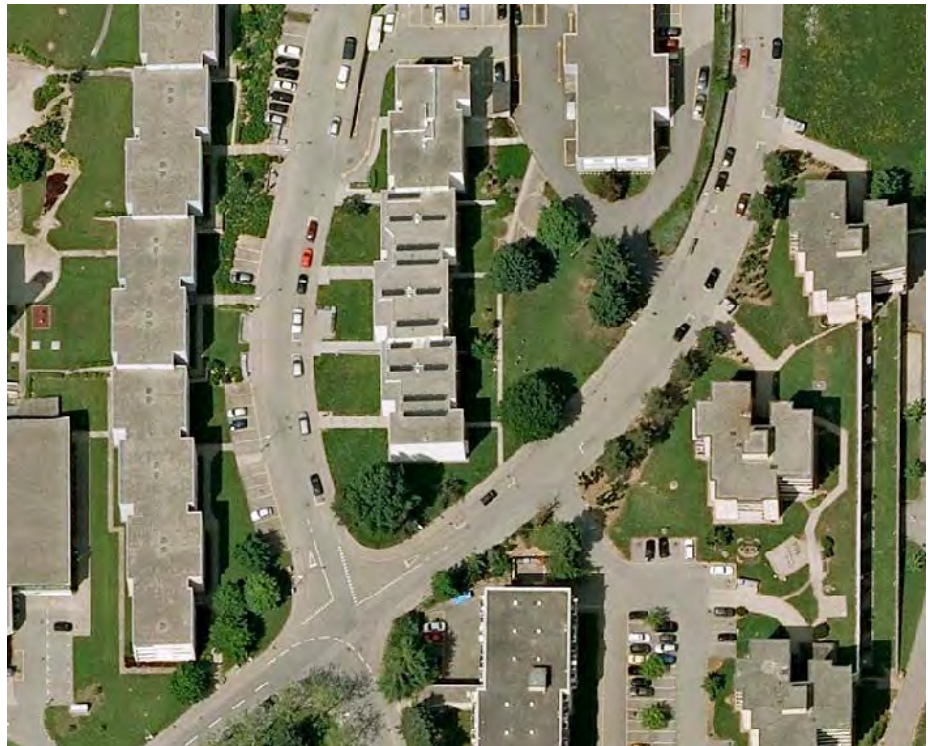
Abbildung 4: Südorientierte Kollektoren auf dem Flachdach mehrerer Wohngebäude in der Stadt Freiburg (Bildmitte). Quelle: Orthophoto 2008-2009, © Staat Freiburg
