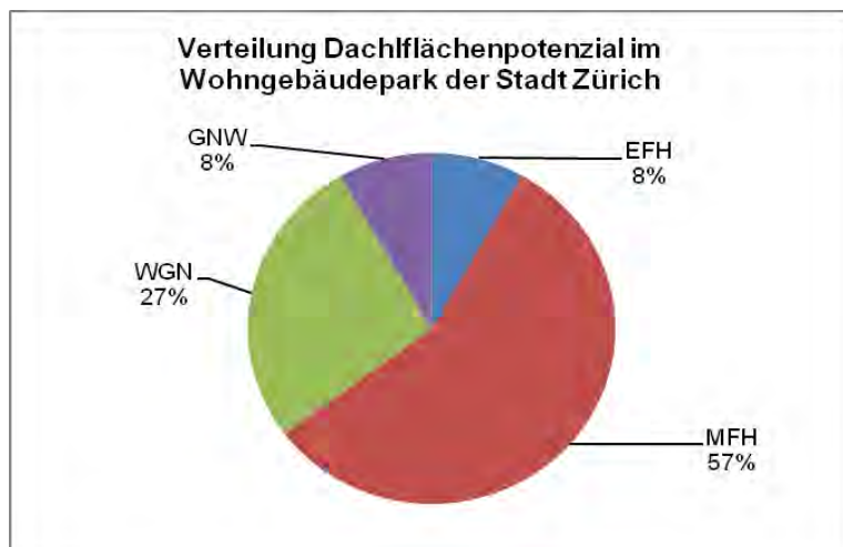
Abbildung 18: Verteilung des Dachflächenpotenzials nach Wohngebäudekategorien in der Stadt Zürich (EFH = Einfamilienhaus, MFH = Mehrfamilienhaus, WGN = Wohngebäude mit Nebennutzung, GNW = Gebäude mit Nebennutzung Wohnen)
